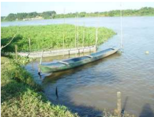
Canoa litorânea de Iguape (SP). Verifique-se que o fundo é levemente arqueado, fazendo com que a proa “flutue” acima da linha d’água quando a canoa está descarregada. A proa é mais larga do que a popa, mas o centro de gravidade situa-se mais à ré da embarcação.
